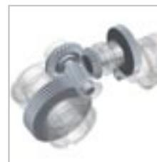
Untersetzungsverhältnisse von jeder Stufe, optimiert zwischen 2 und 6, kombiniert mit geeigneten Abmessungen der Zahnräder: Ergebnis sind größere und zahlreichere Zähne (Modul) auf jedem Rädergetriebe und eine bessere Aufteilung der Lasten zwischen den einzelnen Stufen. All dies beeinflusst sowohl die Übertragungsdauer als auch den Übertragungsmoment.
