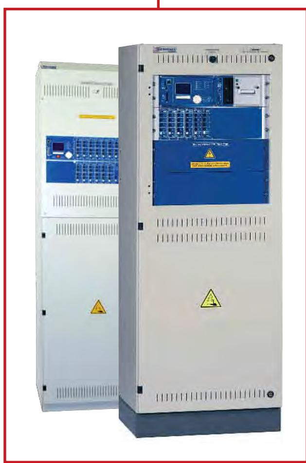
Systémy záložních zdrojů s centrálním napájením jsou navrženy s ohledem na skutečnost, že energie pro případ výpadku je soustředěna v jednom místě. S ohledem na zajištění bezpečné dodávky i v případě lokálního požáru je nutné, aby zařízení bylo umístěno ve vlastní požárně odolné místnosti a svítidla byla připojena požárně odolnými kably. Vzhledem k možnosti připojit k hlavní centrále podružné substanice získává systém na flexibilitě a může být proto upřímněn pro konkrétní projektové požadavky.
