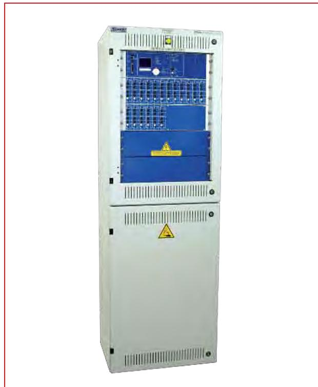
Záložní systém s centrální baterií MidiControl umožňuje zjednodušení přípravných prací při přípravě projektu. Jedná se o předkonfigurovaný systém poskytující maximální výkon 5 300 W při době zálohy 1 hodina, 2 300 W při 3 hodinách nebo 1 000 W při 8 hodinách.
