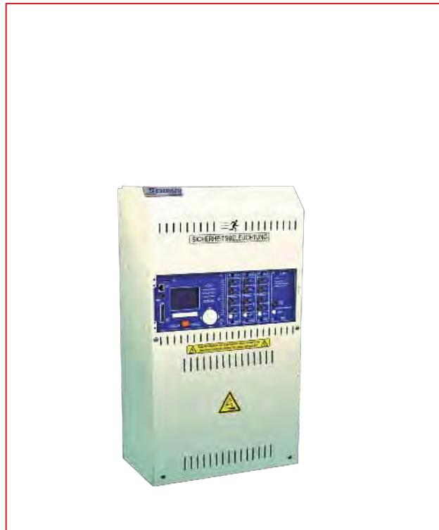
MicroControl představuje decentralizovaný systém určený pro zálohování svítidel nouzového osvětlení. Jedná se o systém s omezeným výkonem (LowPower System) s maximálním zatížením 500 W. Zařízení je optimalizováno pro napájení LED nouzových svítidel.
